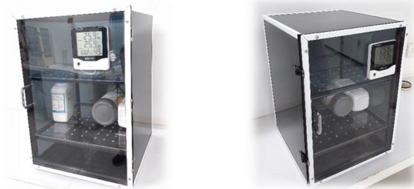
รูปที่ 1 ตู้ควบคุมความชื้นที่พัฒนาขึ้น
