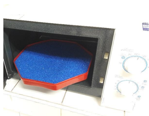
รูปที่ 2 เม็ด silica gel ที่ผ่านการอบไล่ความชื้นด้วยตู้อบลมร้อน (A) และ เตาอบคลื่นไมโครเวฟ (B)
